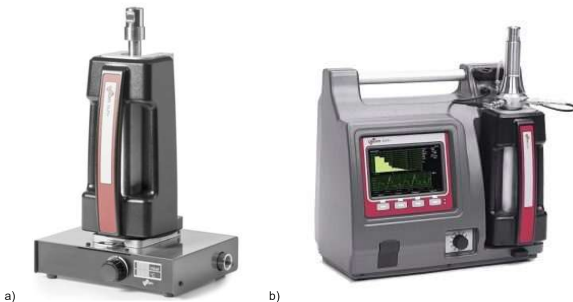
Figure 14 : Photographies des deux analyseurs classiques utilisant le principe d'impaction : le DLPI+ (a) et l'ELPI+ (b), marque DEKATI.
