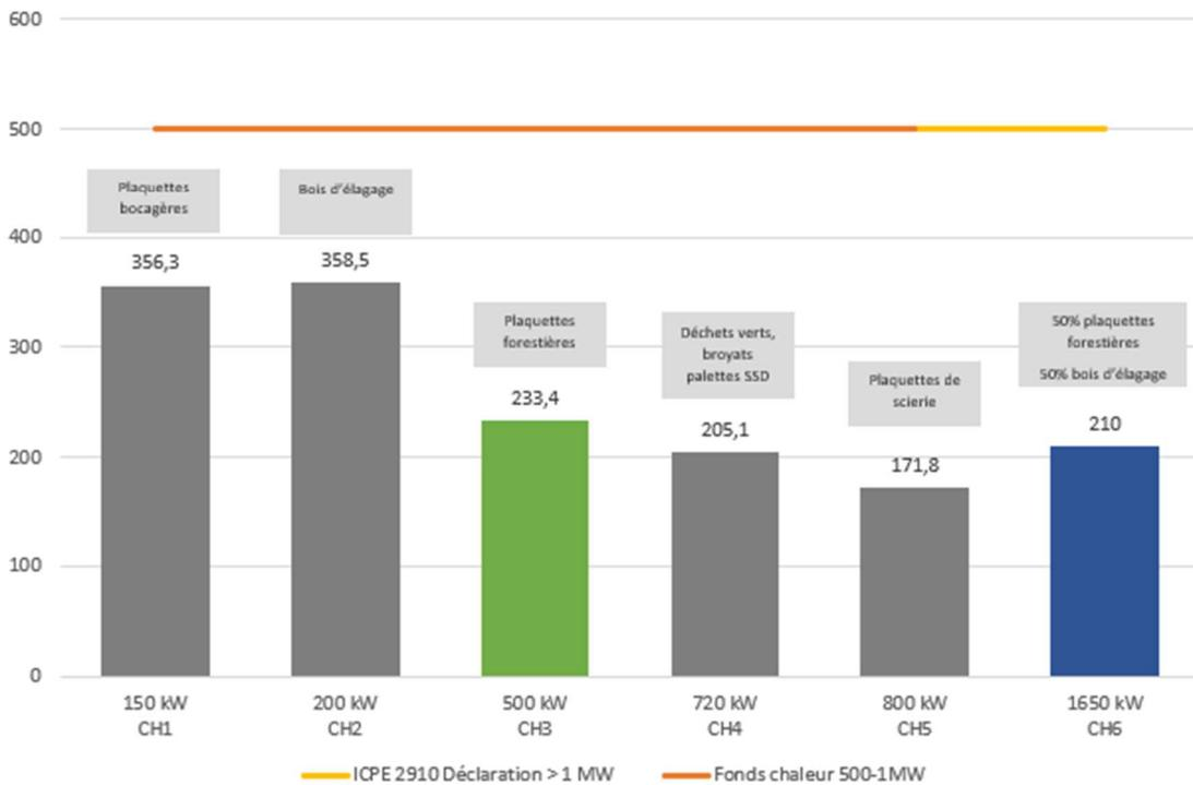
Figure 1 : Résultats des campagnes de mesures pour les CO, les particules solides (SP) et les NOx pour les six chaudières ramenés à 6 % d'O<sub>2</sub>.
