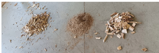
Trois fractions granulométriques séparées par criblage
