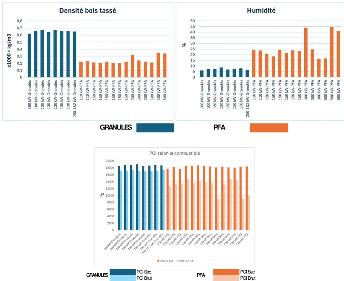
Figure 15 : Paramètres physiques des échantillons de combustibles (Granulés en bleu et PFA en orange) analysés pour chaque chaudière selon les lots livrés lors des mesures.
