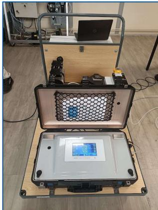
Figure 4 : Illustration de l'analyseur MIR 9000P.
